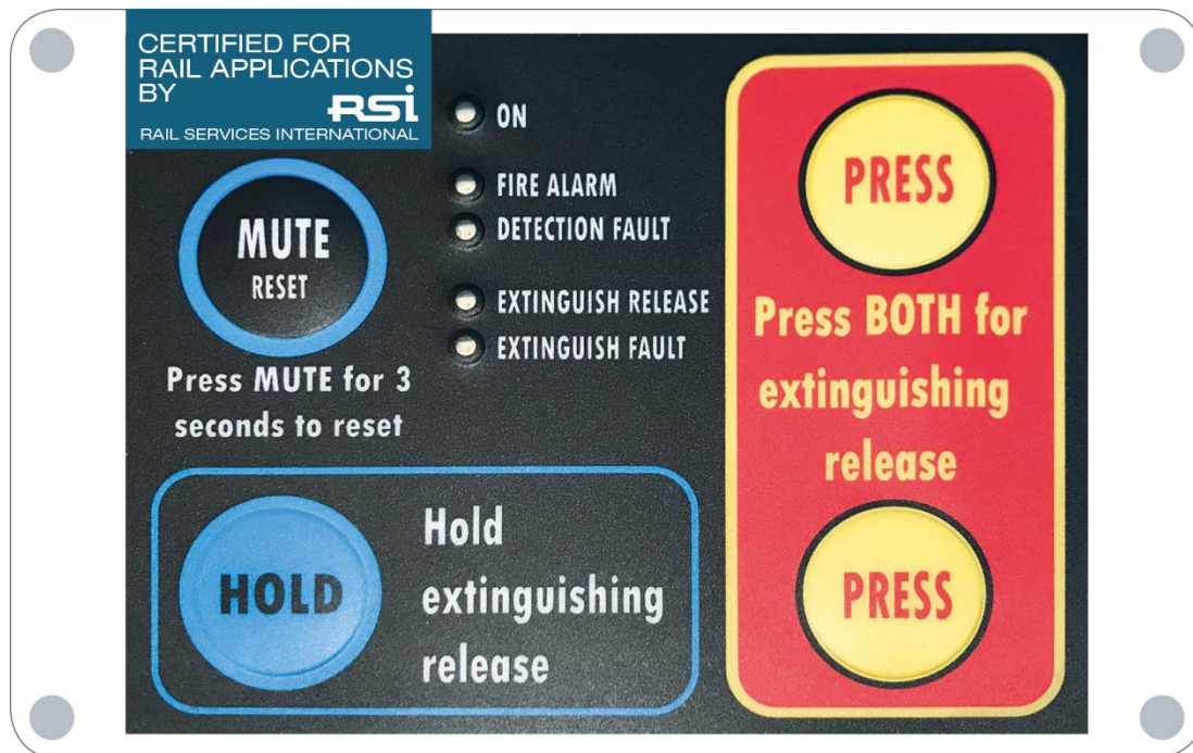
Abbildung 3 - Bedienelemente und Anzeigen auf der Vorderseite des SFCP Rail
